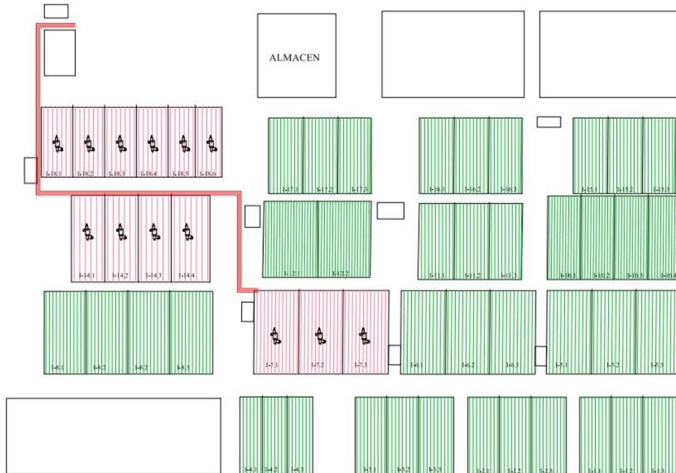
*Croquis de la distribución de tuberías para los diferentes sectores de riego para hidropónico en los invernaderos experimentales.*
